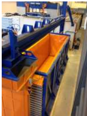
Simulatore sismico per lo studio del comportamento di opere e sistemi geotecnici attraverso prove su modelli fisici in scala.
