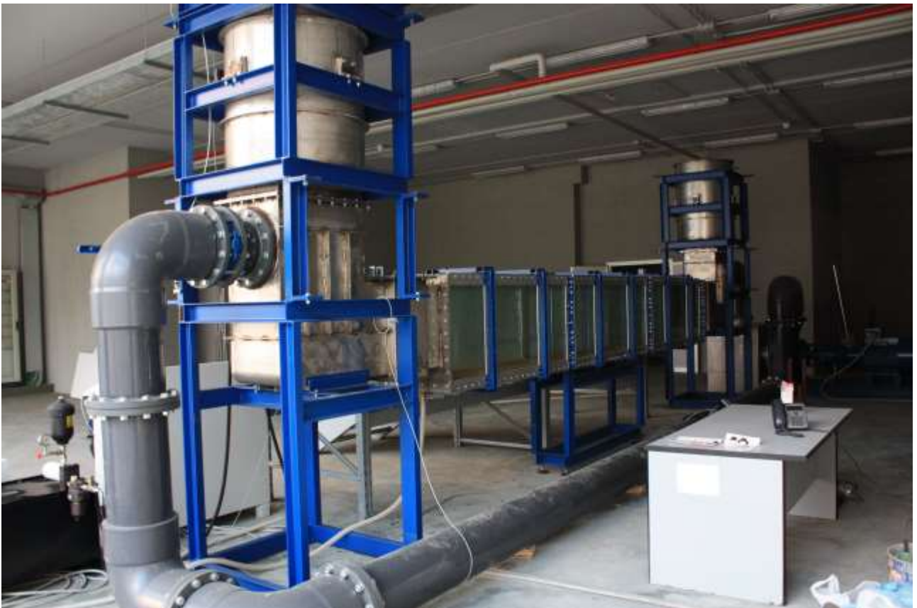
Figura 4: Tubo a U con, in primo piano, il sistema di ricircolo delle correnti.
