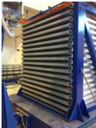
Simulatore sismico per lo studio del comportamento di opere e sistemi geotecnici attraverso prove su modelli fisici in scala.
