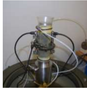
Attrezzature per prove geotecniche di laboratorio su provini di piccole, medie e grandi dimensioni: a) taglio diretto e residuo ( L = 150 \div 300 mm); b) colonna risonante e taglio torsionale ciclico ( D = 38 \div 100 mm); c) granulometro a scansione di immagine; d-e) prove triassili monotone, cicliche e dinamiche ( D = 38 \div 200 mm); f) misure con trasduttori locali.
