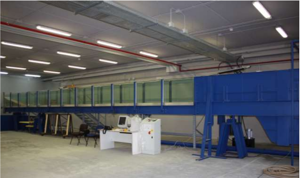
Figura 1. Canaletta a fondo inclinabile con sistema di controllo
