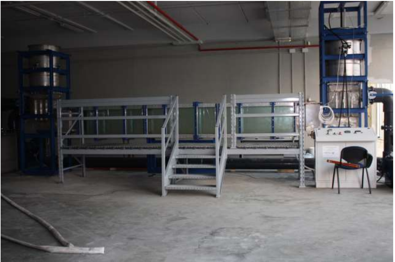
Figura 3: Tubo a U e sistema di controllo
